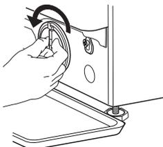
4. Vyměňte filtr: Pod vodní filtr rozložte dobře savou bavlněnou látku. Následně otáčením proti směru hodinových ručiček vodní filtr vyměňte.
