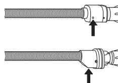
Hadice s automatickým systémem zastavování přívodu vody: zkontrolujte malé inspekční okénko na bezpečnostním ventilu (viz šipka). Je-li červené, byla aktivována funkce bezpečnostního uzavření a hadici je třeba vyměnit za novou. Chcete-li tuto hadici odšroubovat, stiskněte přitom uvolňovací tlačítko (je-li jím vybavena).
