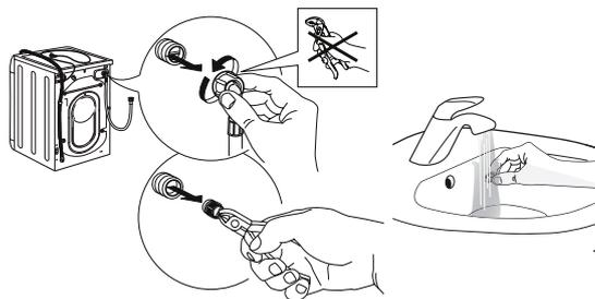
4. Vložte sítkový filtr zpět na své místo. Připojte hadici k pračce i k přívodu vody. Při našroubování hadice nepoužívejte žádné nástroje. Otevřete přívod vody a zkontrolujte, že všude těsní.
