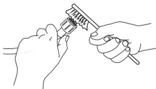
3. Přívodní hadici následně rukou odšroubujte od vstupu na zadní straně pračky. Kleštěmi vyjměte sítkový filtr z přívodní hadice k pračce a pečlivě jej vyčistěte.
