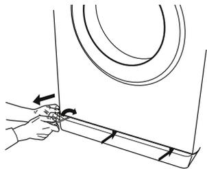
2. Nádoba na odvedenou vodu: Pro zachycení zbytkové vody umístěte pod vodní filtr nízkou a širokou nádobu.
